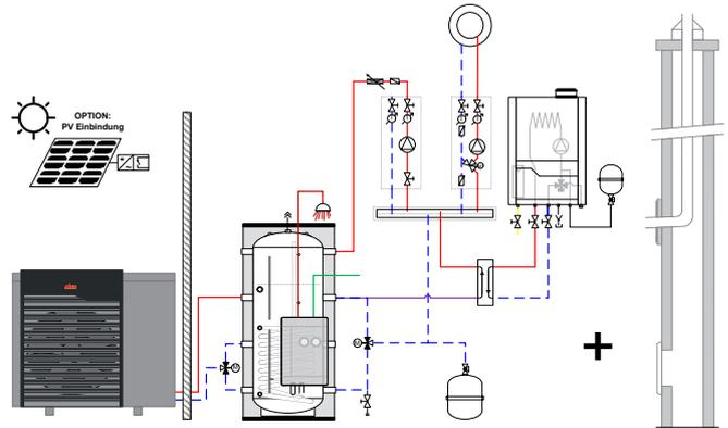
**Komplett-Heizsystem AEROTOP® SX und THISION® S PLUS mit Pufferspeicher und FRIWA, Abgassystem**
